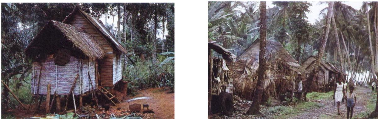
**Fig. 13** – Estrutura das casas na Ilha de São Tomé e Príncipe: elevação do solo, estrutura de madeira e escadas de acesso o interior. Fonte: BRITO (1997, p. 100).
